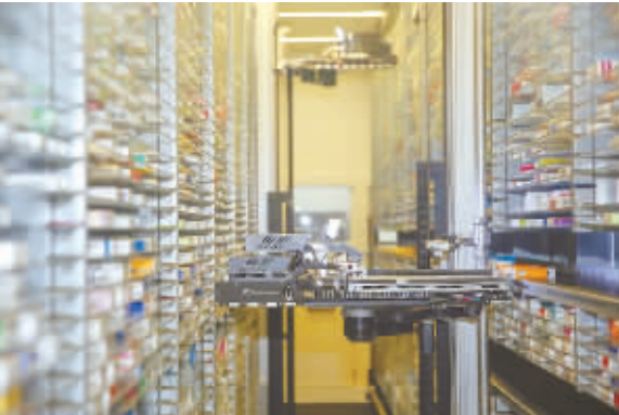
药品机器人(药房全自动传输系统)按照医生处方取药
